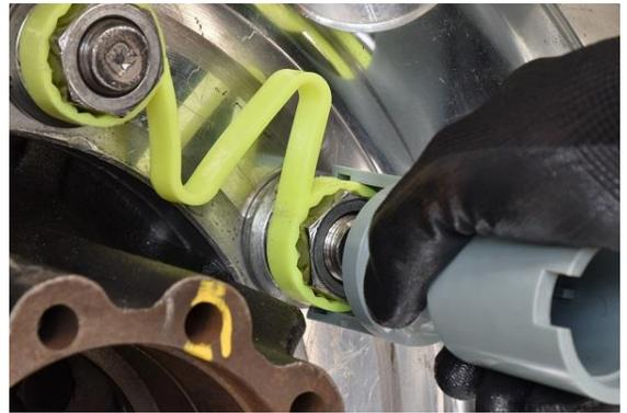
チェックポイントは指示板の対角側面から、チェックリンクは連結部の対角側面からしっかりと爪部を差し込み、そのまままっすぐ手前に引き抜くとナットからインジケータが外れます
