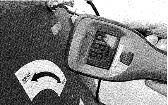
写真①1分当たり93リットルもの窒素ガスを発生。その高い発生量とチャージ能力によってタイヤ4本同時充てんを実現。手間と時間がかかる窒素ガス充てん作業を容易にした。②ハンディタイプの「N2濃度テスター」。タイヤに充てんした窒素ガスの濃度を、ユーザーの目の前で示すことができるので、説得力を向上させている。
