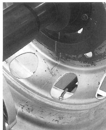
ウエイト取付けに役立つレーザーライン
