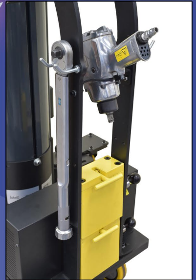
インパクトレンチなどの工具を収納できるツールフックおよび着脱式カウンターウェイト
